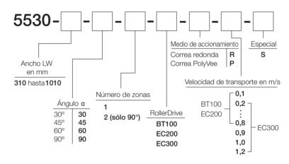
Para la selección del RollerDrive, véanse las indicaciones de aplicación a partir de la p. 124. Si necesita una versión diferente de la versión estándar, agregue una "S" al final y describa sus requerimientos.
