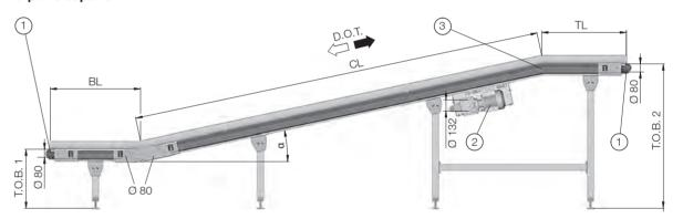
Fig.: Interroll Belt Conveyor BM 4081 Inclined/Declined (Center Drive) con acodamiento del bastidor en la parte superior y banda avanzada o retrasada en la parte inferior
