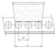
• Seleccionar el hueco de transferencia LG en todos los transportadores de forma que el hueco equivalga a menos de un tercio de la longitud de la carga a transportar
