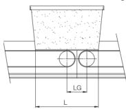
• En el caso de una transferencia entre un transportador de banda y un transportador de rodillos, seleccionar el paso entre rodillos P y el hueco de transferencia LG de tal manera que el hueco equivalga a menos de un tercio de la longitud de la carga a transportar y que, al abandonar un transportador, se encuentren al menos dos rodillos transportadores debajo de la carga a transportar
