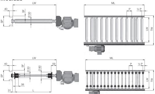
**Dimensiones** 210 hasta 1210 mm en pasos de 50 mm LW Ancho ML Longitud máx. del módulo 6000 mm TW Ancho del módulo LW + 100 mm L Ancho útil LW - 90 mm P Paso entre rodillos 63 / 75,5 / 82 / 101,5 / 126,5 / 151,5 mm SP Perfil lateral 120 / 150 mm SF Guía lateral 35 / 65 mm
