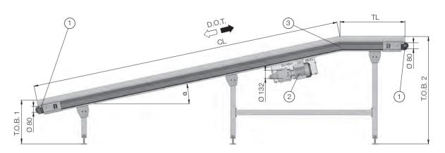
Fig.: Interroll Belt Conveyor BM 4081 Inclined/Declined (Center Drive) con acodamiento del bastidor en la parte superior
