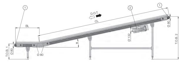
Fig.: Interroll Belt Conveyor BM 4081 Inclined/Declined (Center Drive) con banda avanzada o retrasada
