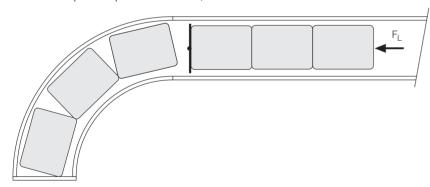
El paso entre rodillos y la medida del hueco de transferencia entre dos transportadores son muy importantes para un transporte sin interferencias.
