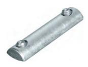
Los conectores de perfil conectan los perfiles laterales de dos transportadores dentro de una línea. Su forma especial garantiza la alineación de los perfiles laterales. Normalmente se necesitan cuatro conectores de perfil para conectar dos módulos de transporte entre sí.
