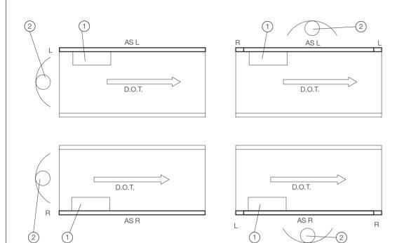
Fig.: Lado de accionamiento a la derecha (R) e izquierda (L) y unidades de reenvío
