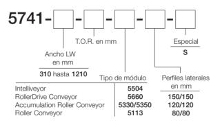
Si necesita una versión diferente de la versión estándar, agregue una "S" al final y describa sus requerimientos. Por favor, indique qué módulo de su pedido debe montarse en la Lift Up Gate.
