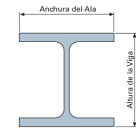
El dato más importante a la hora de seleccionar un carro, independientemente de la carga y del tipo de viga, es la anchura del ala de la misma.
